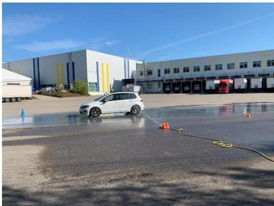
Die erste Übung bestand darin, eine Gefahrenbremsung durchzuführen. Gesteigert wurde die Schwierigkeit, als wir nicht auf normalem Asphalt bremsen sollten, sondern auf einem besonderen Belag, der die Haftbarkeit von nassem Laub zeigen sollte. Der Bremsweg war auf dieser Oberfläche deutlich länger, als wir ihn zuvor geschätzt hatten.
